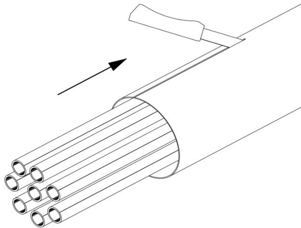
1) Rohrverband mit einem Messer ca. 0,5m in Längsrichtung aufschneiden.
