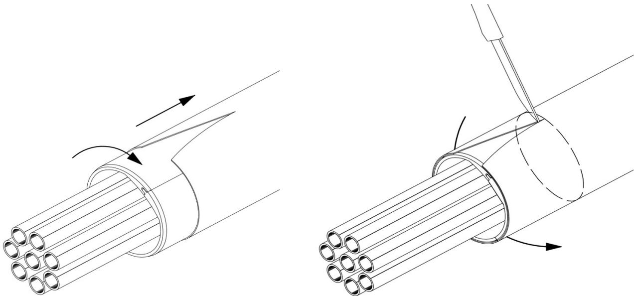
2) SHi von Hand aufweiten und um das speedpipe-Bündel in den speedpipe-Rohrverband führen.
