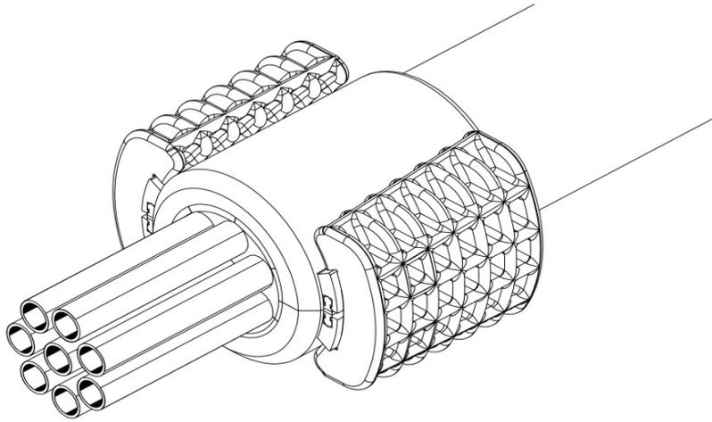
5) Nach dem Ablängen des Mantelrohrs, Stützhülse bündig in das Mantelrohr des SRV schieben. Anschließend EZA-t auf den Rohrverband montieren.
